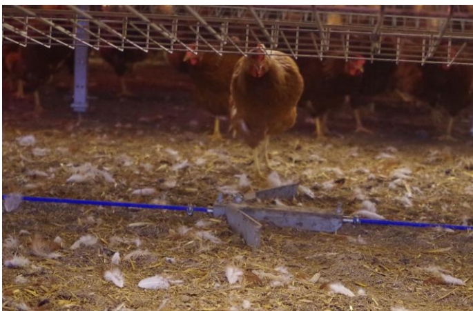
Abb. 76: Kotschieber unter dem System (links) und im Außengang (rechts).
