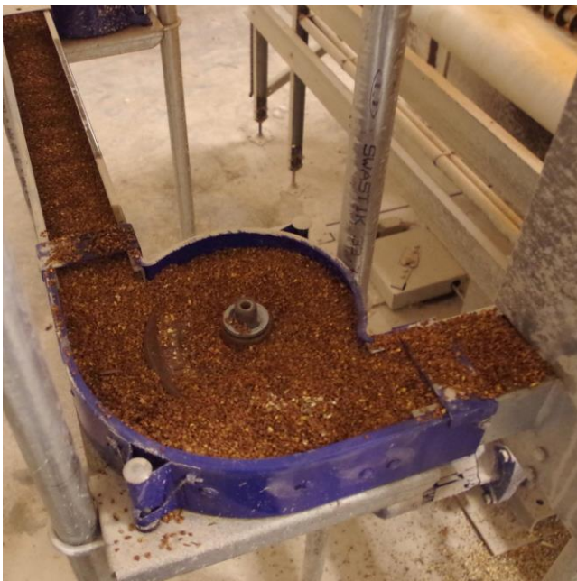
Abb. 29: Durch stehendes Wasser in der Futterkette hat sich Rost gebildet, was sich mit dem frischen Futter vermengt hat. Dies muss unbedingt vermieden werden.
