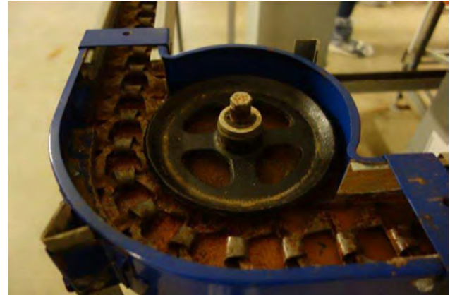
Abbildung 4: Rostrückstände an der Futterkette
